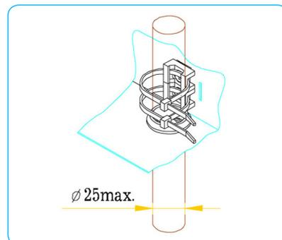
Крепление кабеля стяжки CSHV-2K
